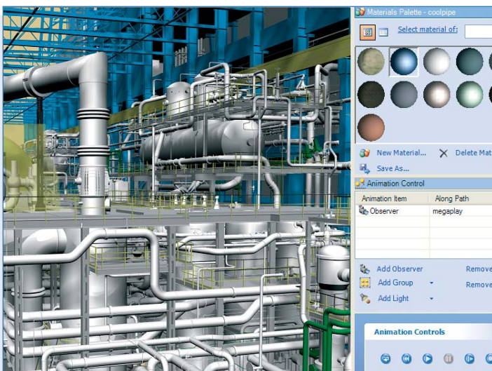
Controles de material, textura e iluminación para visualizaciones de elevado realismo Cortesía de Paks Nuclear Plant Company, Hungría
